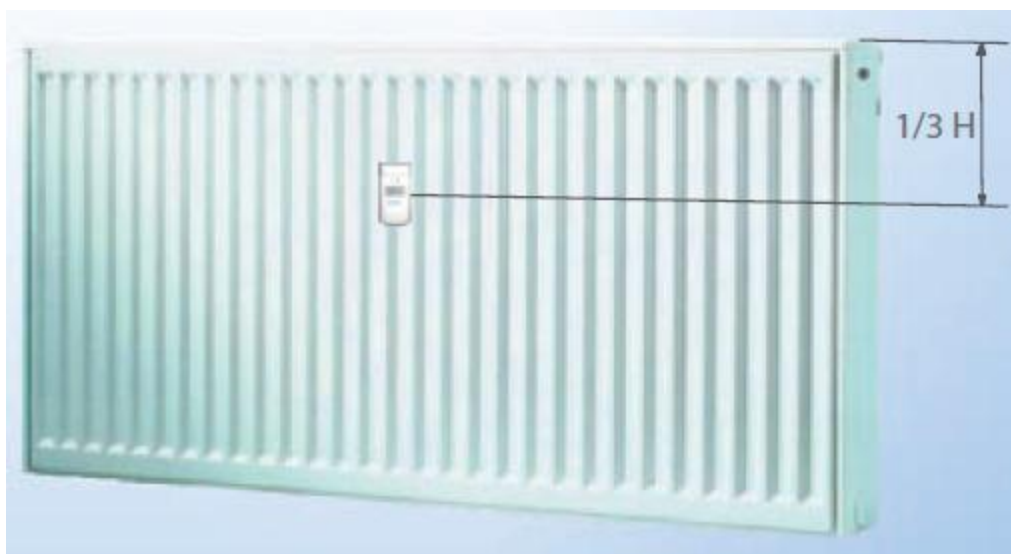
Rys. 1 Umiejscowienie podzielnika na grzejniku
